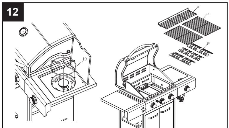
**!** ACHTUNG: ES IST SEHR WICHTIG, DASS ALLE BRENNER KORREKT MIT DEN ANGRENZENDEN VENTILEN VERBUNDEN IST BEVOR SCHRITT 10 ABGESCHLOSSEN WIRD. ANSONSTEN KANN ES ZU FEHLFUNKTIONEN KOMMEN WELCHE FEUER ODER EXPLOSIONEN HERVORRUFEN KANN. DIESE KÖNNEN ZU SCHWEREN VERLETZUNGEN ODER SOGAR ZUM TODE FÜHREN. WEITERE INFORMATIONEN ZUM PRÜFEN DER KORREKTEN VERBINDUNGEN FINDEN SIE IM WARTUNGSABSCHNITT.
