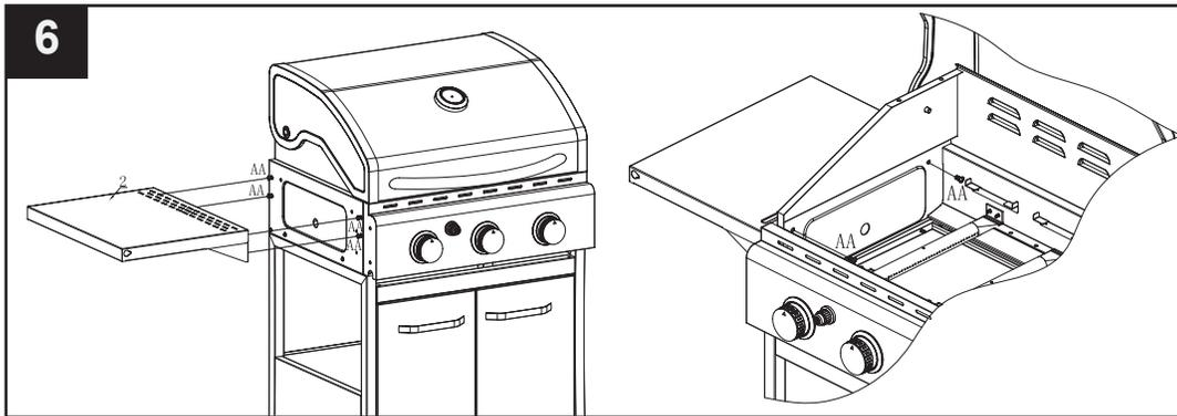
Montieren Sie zunächst den Flaschenöffner (7) am linken Frontpanel (3) mit den M4 x 10 mm Schrauben (JJ). Verschrauben Sie die M6 x 12 mm am linken Frontpanel. Lassen Sie 5 mm Abstand. Montieren Sie dann das linke Frontpanel (3) mit dem Korpus mit den M5 x 10 Schrauben (BB).
