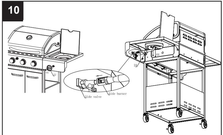
Setzen Sie den Drehknopf (23) auf das seitliche Ventil. Montieren Sie dann die Zündnadel am seitlichen Brattisch mit den M4 x 8 mm Schrauben (GG).
