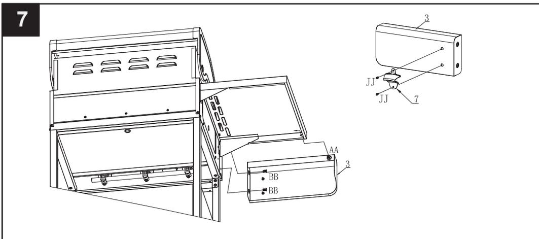
Montieren Sie die M6 x 12 mm Schrauben (AA) am Korpus. Lassen Sie 5 mm Abstand. Bringen Sie dann den seitlichen Brattisch (20) am Korpus mithilfe der M6 x 12 mm Schrauben an (AA).
